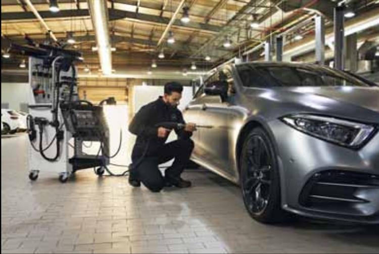
Bei der Dellenreparatur werden kleine Dellen rückseitig ausgedrückt: mit Spezialwerkzeugen und vor allem mit Fingerspitzengefühl. Ein Schleifen, Spachteln oder Lackieren ist nicht notwendig.
